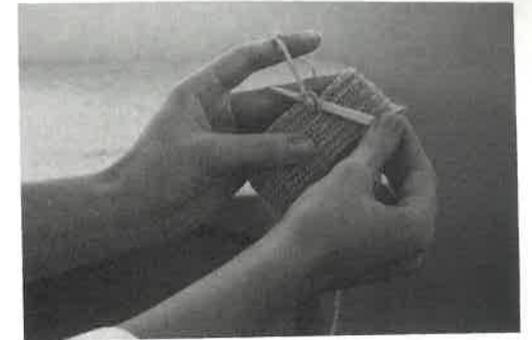
Foto 4: Anfertigung eines Probestückes; typische Nadelform und Arbeitshaltung
