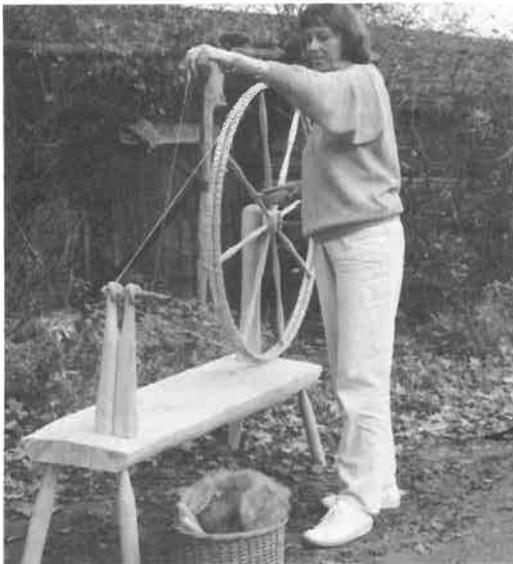
Abb. 4.3: Der Faden wird im rechten Winkel zur Achse aufgewickelt.
