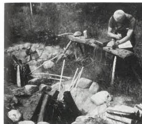
Abb. 9: Temperaturmessung mit NiCr-Ni-Thermoelementen in Edelstahlgefäßen.
