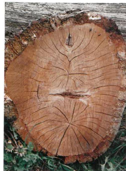
Abb. 1: Querschnitt durch einen Eichenstamm mit deutlich sichtbarem Splintholz - bereits stark verrottet.
