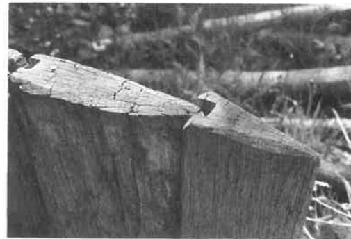
Abb. 3: Spaltbohlenwand mit Nut und Feder - Versuchsanordnung.
