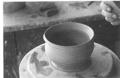
Abb. 5: Zwischenstadium beim Drehen eines Kugeltopfoberteils, hier mit Innenfurchen.
