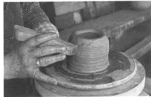
Abb. 4: Beginn des Drehens am handvorgeformten Hohlkörper.
