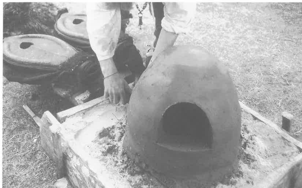
Abb. 4: Aufbau eines kuppelförmigen Lehmofens für die Fertigung von Glasperlen, wie sie in Haithabu gefunden wurden.
