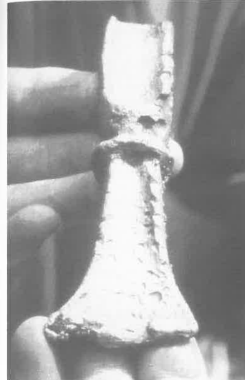
Abb. 12: Gussergebniss eines Absatzbeiles im Wachsausschmelzverfahren mit starken Fehlern durch das Abplatzen von Formmaterial beim Brennen der Form.
