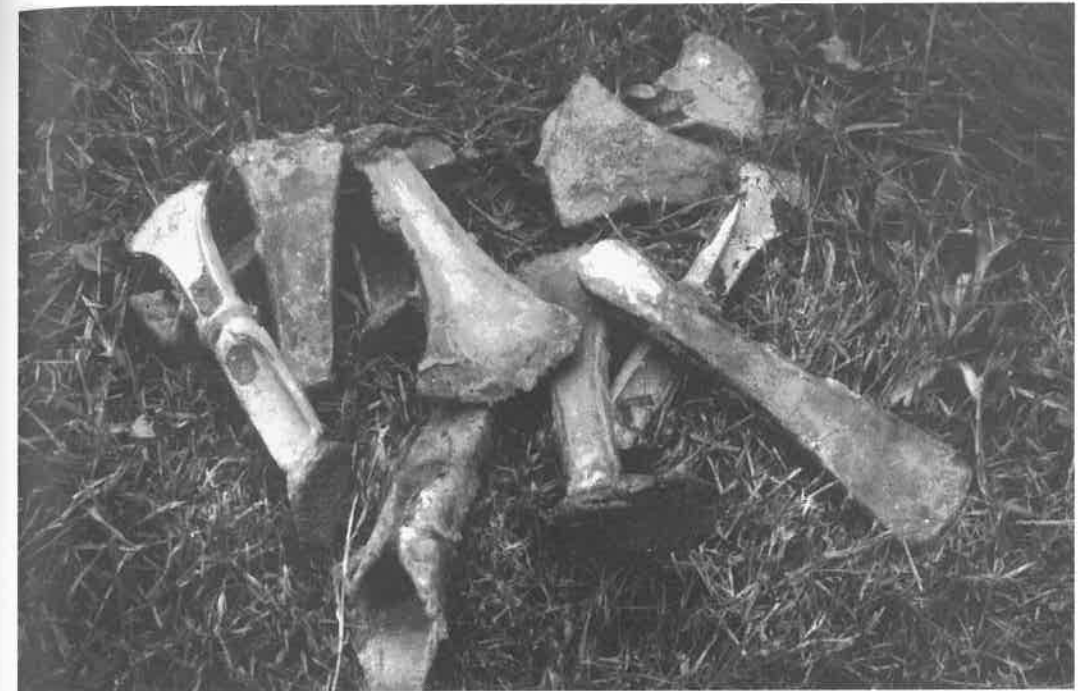
Abb. 10: Gussergebnisse unserer Versuche an Bronzeaxtklingen mit verschiedenem Formenmaterial.
