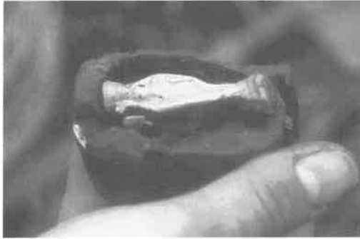
Abb. 6: Eine im Wachs-Ausschmelz-Verfahren ausgegossene Lehmform mit einer dreiflügligen Tüllenpfeilspitze beim Ausbetten.
