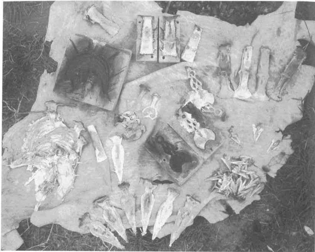
Abb. 11: Gussergebnisse einer dreitägigen Bronzegussvorführung mit überwiegend guten Gusserfolgen.
