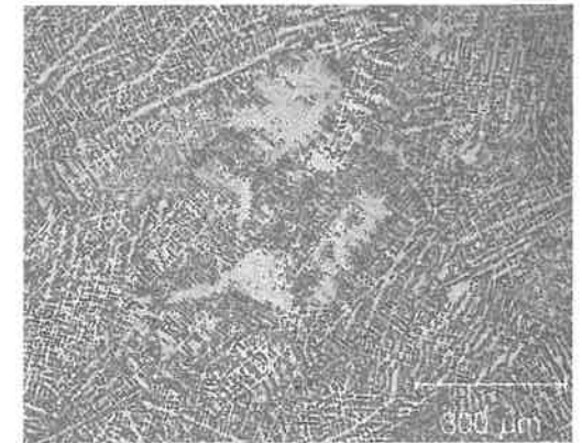
Abb. 9: Schliffbild eines in einer Metallform gegossenen Armreifs.
