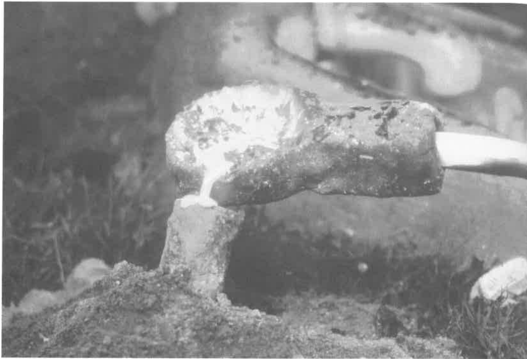
Abb. 3: Gussvorgang beim Gießen einer verlorenen Form mit der Knickdüse. Der Löffeltiegel wird mittels eines zum Gießen eingeführten Holzstabes bewegt.
