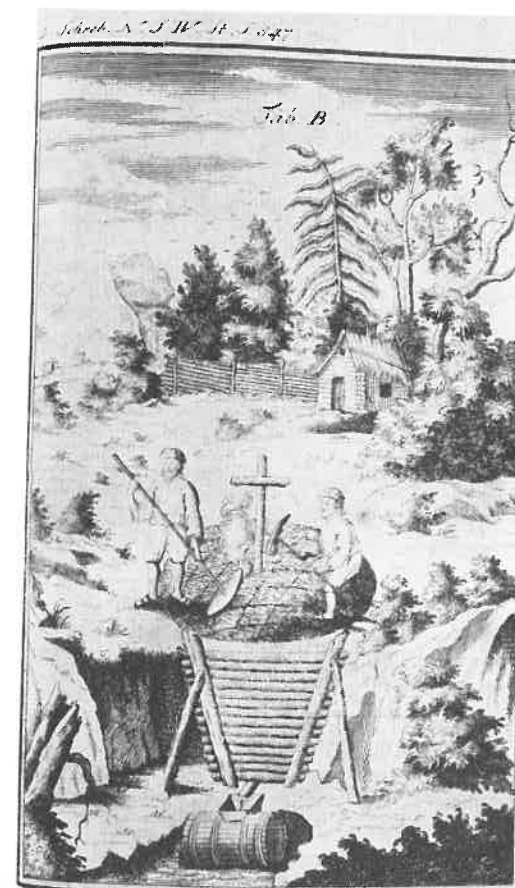
Abb. 4: Gewinnung von Holzteer durch Grubenschwelerei in Österbotten. Kupferstich von J. H. Seeliger nach einer Zeichnung von A. Dahlsteen (1749). Royal Library, Stockholm.
