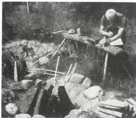
Abb. 9: Temperaturmessung mit NiCr-Ni-Thermoelementen in Edelstahlgefäßen.
