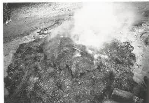
Abb. 18: Nach Abdecken mit Sandsoden wurde der Grubenmeiler in Betrieb genommen.
