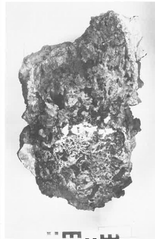
Abb. 4: In der Längsachse durchgetrennter Experimentalofen Tscherno 6 mit großem Schlackeklotz und „Luppenzone.“
