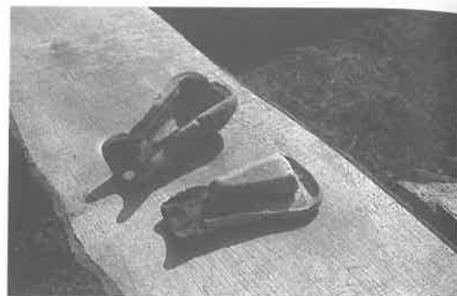
Abb. 32: Gebrannte und geöffnete Gußform (Form III). Der Kern im Unterteil ist deutlich zu sehen.
