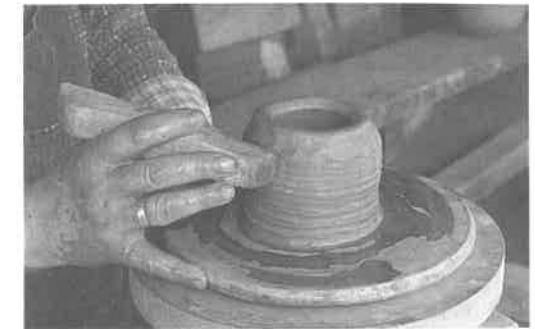
Abb. 4: Beginn des Drehens am handvorgeformten Hohlkörper.
