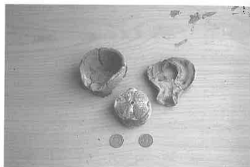
Abb. 34: Rohguß und Gußform. Replik G 6a und die Reste von Form V.
