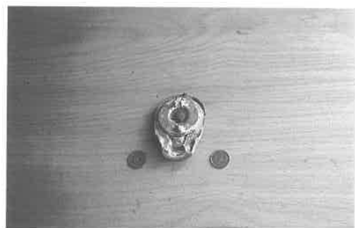
Abb. 35: Rohguß und Gußform. Replik Boden DS a (Messing) und Oberteil von Form VIII. Dieses Gußformteil könnte als einziges wiederverwendet werden.
