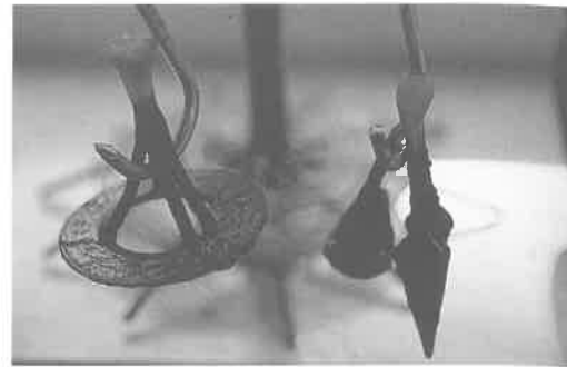
Abb. 6: Ummanteln mit der Holzkohle-Ton-Mischung
