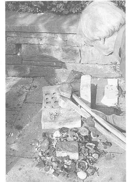
Abb. 9: Fassen der Form mit der Holzzange
