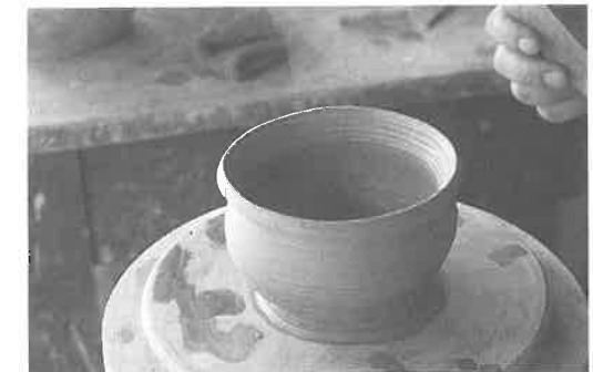
Abb. 5: Zwischenstadium beim Drehen eines Kugeltopfberteils, hier mit Innenfurchen.
