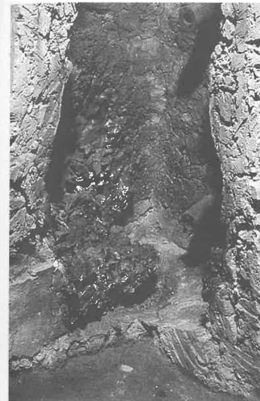
Abb. 5: Schnitt durch einen Ofen zur Verhüttung von Kupferkies. Vor den Düsen liegt ein Schlackenklötz mit Kupferstein, metallischem Kupfer und einigen Eisentröpfchen. An der Rückwand befindet sich ein Schamotterrohr zur Einführung eines Temperaturmeßfühlers.
