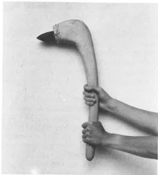
Abb. 1: Schuhleistenkeil, quergeschäftet in einem Knieholm aus Buchenholz.
