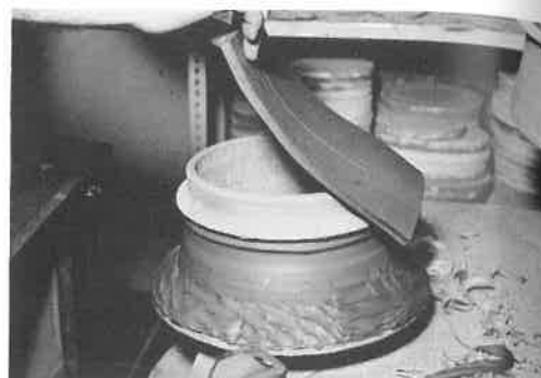
Abb. 15: Auflegen des Tonblattes auf die Formschüssel
