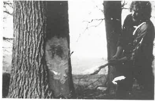
Abb. 1: Fällversuch ML/FE 1 (29). Beim Einsatz des großen Fällbeils (FB 3/4) lösten sich bis zu handtellergroße Späne.
