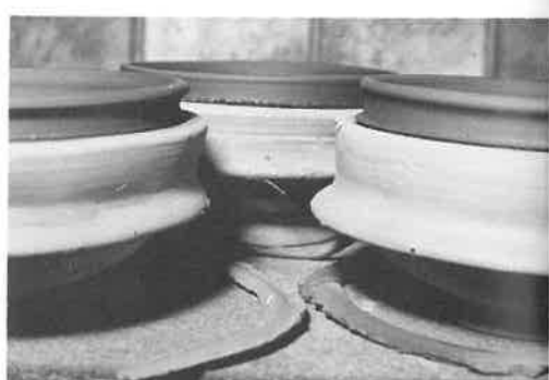
Abb. 19: Die Bilderschüsseln lösen sich durch Schwindung des Tons beim Trocknen von der Form
