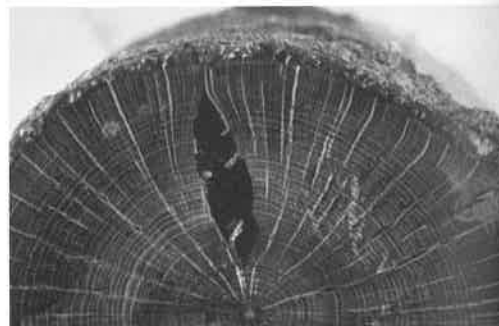
Abb. 9: Profil einer aufgebrochenen Holzkohle mit Feuchtigkeitsspalte.
