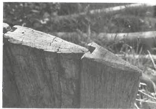
Abb. 3: Spaltbohlenwand mit Nut und Feder - Versuchsanordnung.
