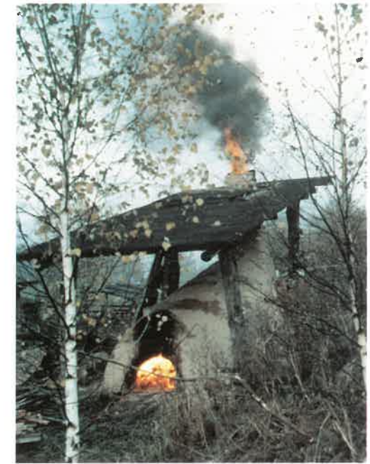
Abb. 2: Liegender Ofen; der „Fuchs“ schlägt durch
