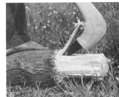
Abb. 8: Herstellen eines Zapfens.
