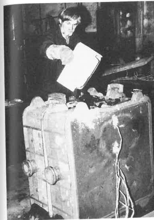
Abb. 4. Versuchsofen des Olomučany-Typus in den Stahlkokillen eingebettet.
