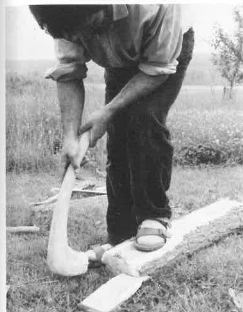
Abb. 6: Spalten eines Eichenstammes.
