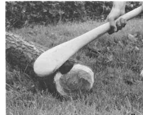
Abb. 5: Zurichten der Stirnseite.
