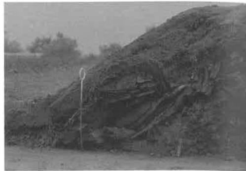
Abb. 7: Meiler EM 1 nach dem Versuch. Profilausschnitt mit kleinstückiger Holzkohle im Meilerzentrum und unverkohlt bzw. angekohltem Holz im Mantelbereich.
