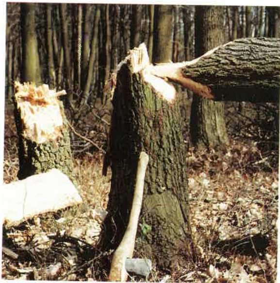
Abb. 2: Fällversuch KM/FE 1 (1). Die Eiche (Ø 28 cm) fiel nach 42 min.
