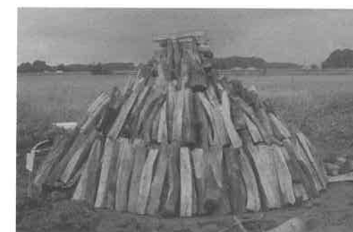
Abb. 2: Vollständig aufgeschichteter Meiler EM 1.
