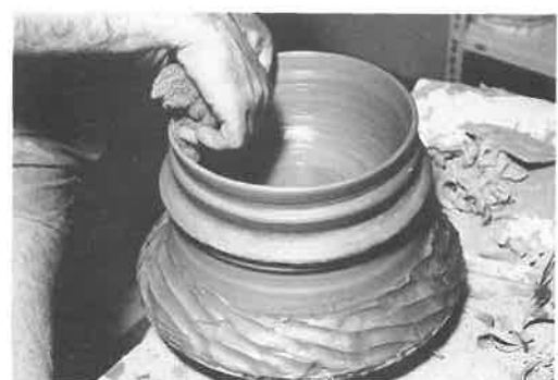
Abb. 18: Herstellung des über die Form ragenden Randes beim Glattdrehen
