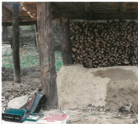
Abb. 6 Verschlossene Einsatzöffnung mit eingebauten Temperatursonden
