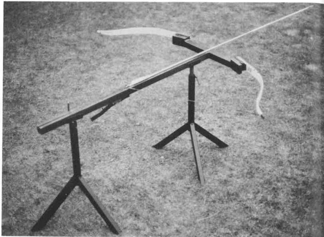
Abb. 1: 1. Der bei den Versuchen verwendete Schußapparat in einsatzbereitem, gespanntem Zustand. 2. Detailaufnahme der Auslösevorrichtung. Durch Hochziehen des Hebels auf der Unterseite der Mittelschiene bewegen sich die beiden Stifte nach unten und geben die Sehne mit dem eingelegten Pfeil frei (Fotos: Verfasser).
