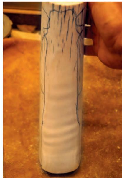
▲ Abb. 6: Auf den großen Flächen entstehen durch Interferenzen zwischen Werkzeug und Werkstück lange „Rattermarken“.
