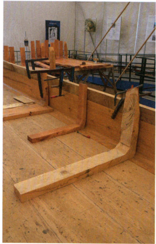
Abb. 3: Einpassung von Spanten in den Schiffsrumpf der Nehalennia. – Adjusting frames in the hull of the Nehalennia.
