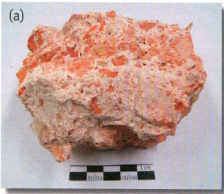
Abb. 1: Handstücke aus Xanten (1a) und Schwarzenacker (1b). Auffällig ist das sehr reine Weiß des Bindemittels aus Xanten. Das Bindemittel der Probe aus Schwarzenacker weist eine mehr ockerfarbene Färbung auf. – Samples from Xanten (1a) and Schwarzenacker (1b). Striking is the very pure white of the binder from Xanten. The binder of the sample from Schwarzenacker has a more ocher coloring.
