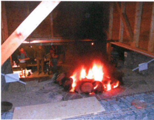
Abb. 2: Flammenauschlag (Reduktionsflamme) während einer reduzierenden Phase. Anhand solcher Merkmale informieren sich Töpfer auch ohne großen apparativen Aufwand über die unterschiedlichen Brenn Atmosphären in ihrem Ofen. – Flames during a reduction phase. According to such characteristics, it was possible for the potter to gain knowledge about the atmospheric conditions inside the kiln without the use of complicated modern equipment.
