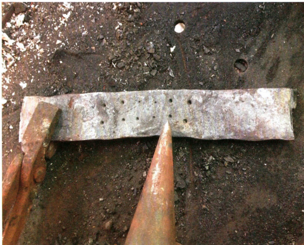
Abb. 1: Zieheisen (30,5 x 5,5 x max. 0,6 cm) mit 11 Ziehholen (von 2,5-5,0 mm) und Werkzeug (Zange, Dorn). – Iron drawplate (30,5 x 5,5 x max. 0,6 cm) with 11 holes (2,5-5,0 mm) and tools (drawtong, prickle).
