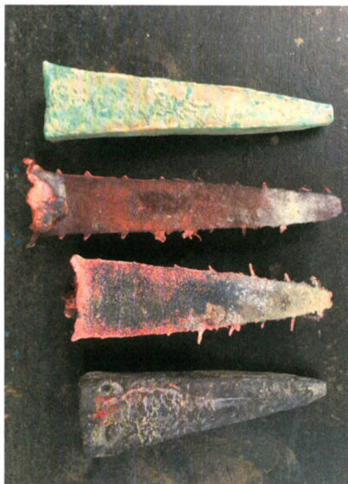
Abb. 8: Zwei der in Sandstein gegossenen Repliken (Mitte) mit den Abgüssen der Originale (oben und unten). – Two of the picks which were casted in sandstone (middle) with the replicas of the original picks.
