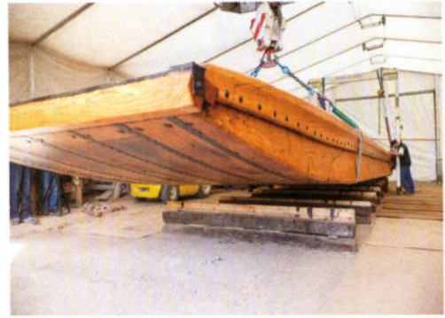
Abb. 4: Eisenbänder zum Schutz der Kalfaterung an den Kaffen. – Iron bands protecting the caulking of the swimhead.
