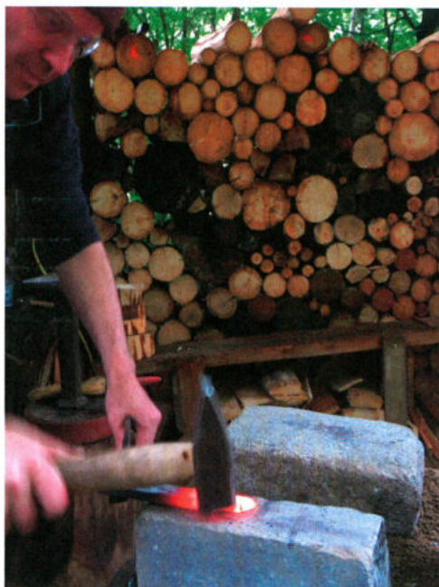
Abb. 3: Im Rahmen unserer praktischen Versuche zur eisenzeitlichen Schmiedetechnologie testeten wir verschiedene Gesteinsarten auf ihre Funktionalität als Ambossteine. – In the course of our practical experiments on Iron Age forging we tested different sorts of stone concerning their functionality as anvils.
