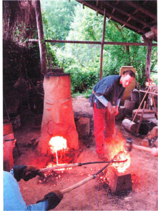
Abb. 1: Experimentelle Versuche zur Verhüttung von Eisenerz im Schachtofen. Die aus Eisenfolien bestehende Luppe mit etwa 5 kg wurde gerade aus dem Ofen genommen und wird nun bei etwa 1.245°C verschweißt, um Verunreinigungen auszuscheiden. – Practical experiments concerning the smelting of iron in a chimney furnace. The iron lump existing mostly of thin foils gets welded at a temperature of about 1.245°C to expel contaminations.
