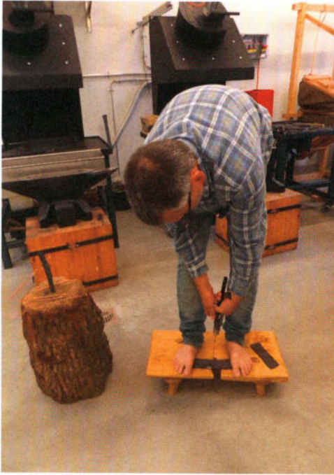
Abb. 3: Drahtziehen mit dem Ziehschemel. – Wire drawing with foot stol.
