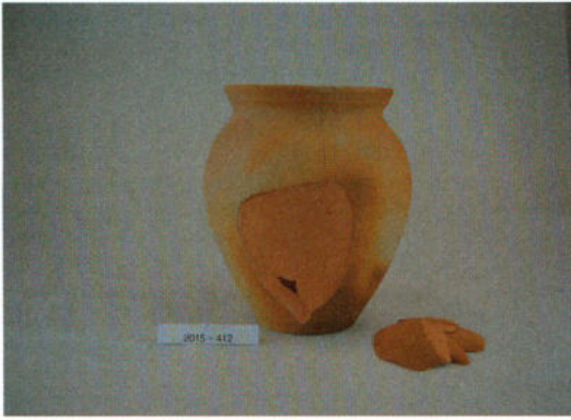
Abb. 10: Inv.-Nr. 2015-412, Ton 0002 Weiß, Anzahl der Durchgänge: 3; Anmerkungen: Das Gefäß hat zwei Durchgänge überstanden und zerbrach beim dritten. Die Brüche erschienen an verschiedenen Stellen und üblicherweise vertikal. Der größte Schaden entstand durch eine flache Absplitterung der Gefäßwand; Inv.-Nr. 2016-075, Ton: MV4 / Weiß 50% – Rot 50%, Anzahl der Durchgänge: 10, Anmerkungen: Das Gefäß hat 10 Durchgänge ohne Schaden überstanden. – Inv.-Nr. 2015-412, Clay 0002 White, Number of passes: 3, Remarks: The vessel has survived two rounds and cracked during the third time. The cracks occurred in several places and usually vertically. The greatest damage was caused by a flat chipping of the vessel wall; Inv.-Nr. 2016-075, Clay: MV4 / White 50% – Red 50%; Number of passes 10; Remarks: The vessel has survived ten passes without damage.
