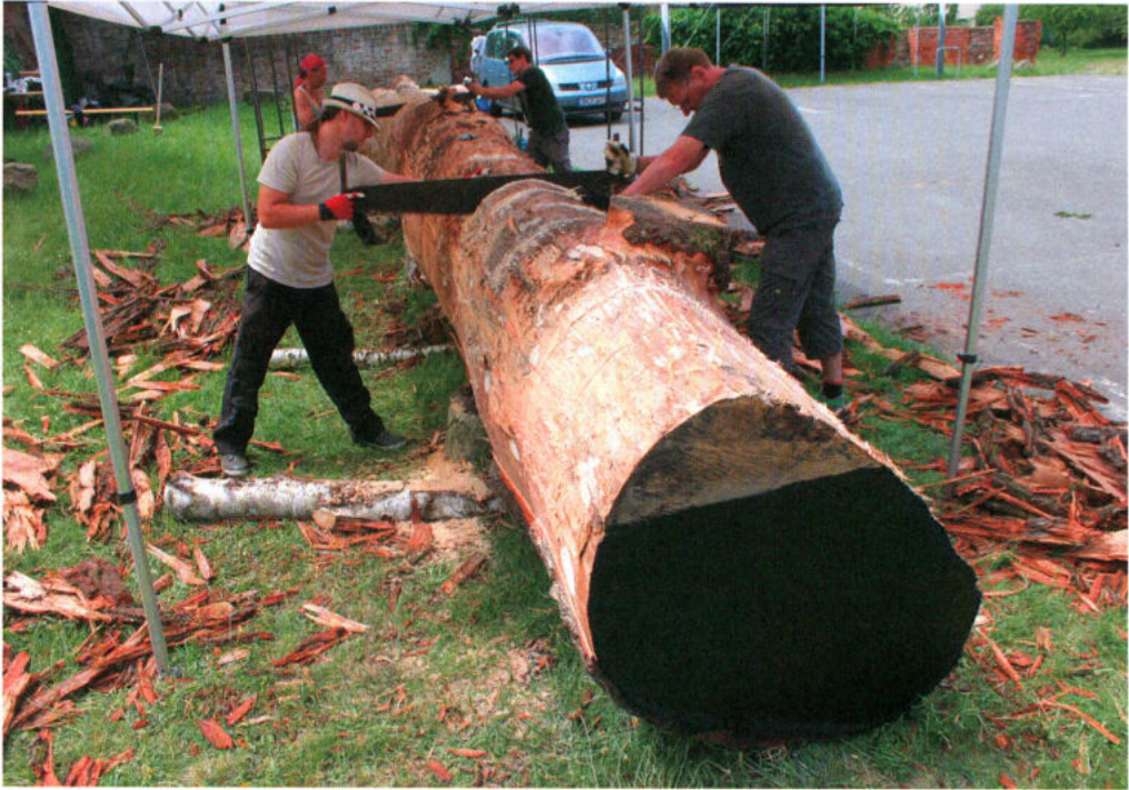
Abb. 3: Einsägen der Kappen. Einsägen vor dem Ausstemmen – Sawing prior to chiseling. Sawing the caps.
