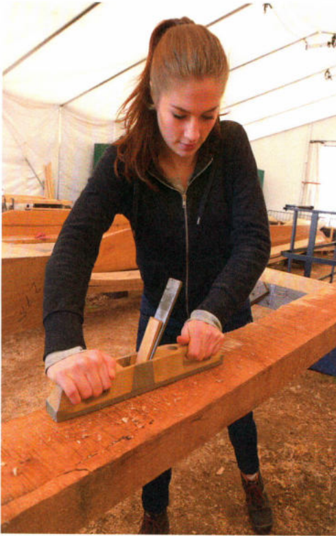
Abb. 2: Erprobung der Rekonstruktion eines in der CUT gefundenen Hobels. – Practical trial of a reconstructed plane found in the CUT.
