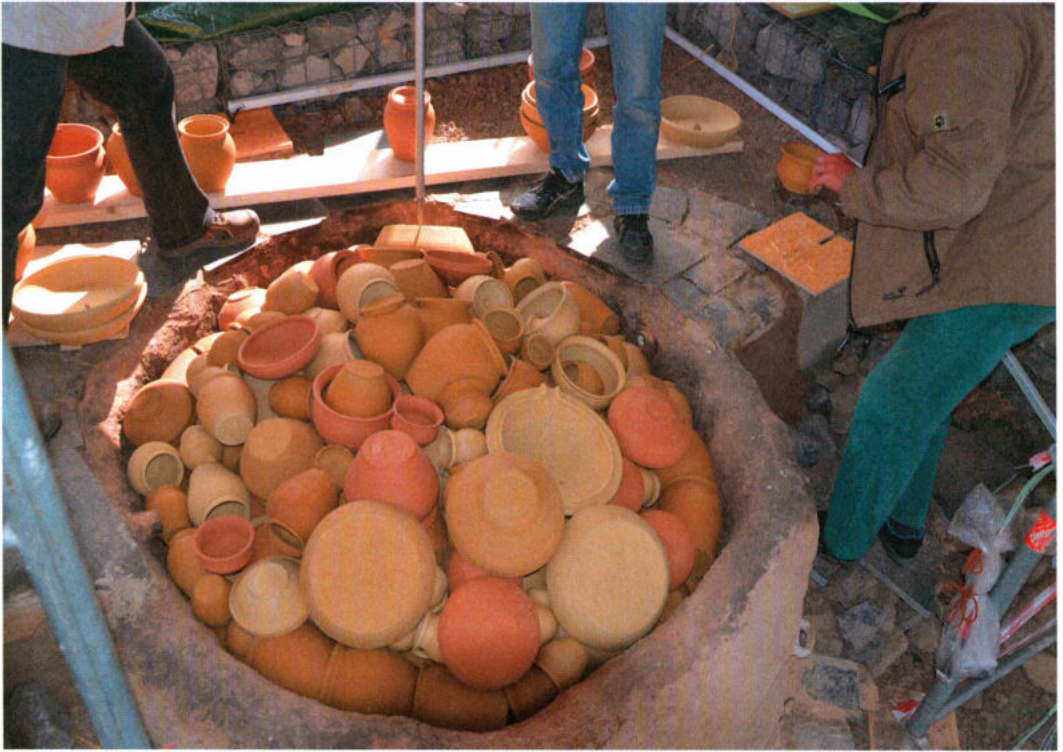
Abb. 3: Das Einstapeln der Waren ohne Stapelhilfen verlangt großes Erfahrungswissen. Das Brenngut muss so eingestapelt werden, dass Flamme und Brenngase so durch den Ofen geführt werden, dass eine gleichmäßige Temperaturverteilung gegeben ist und die Gefäße durch den Stapeldruck nicht beschädigt werden. – Stacking the pots without the help of supports takes quite a lot of practical experience. The wares have to be stacked in a manner that the flames and gasses can circulate through the kiln and create an even temperature but also crack due to uneven pressure on the pot walls.
