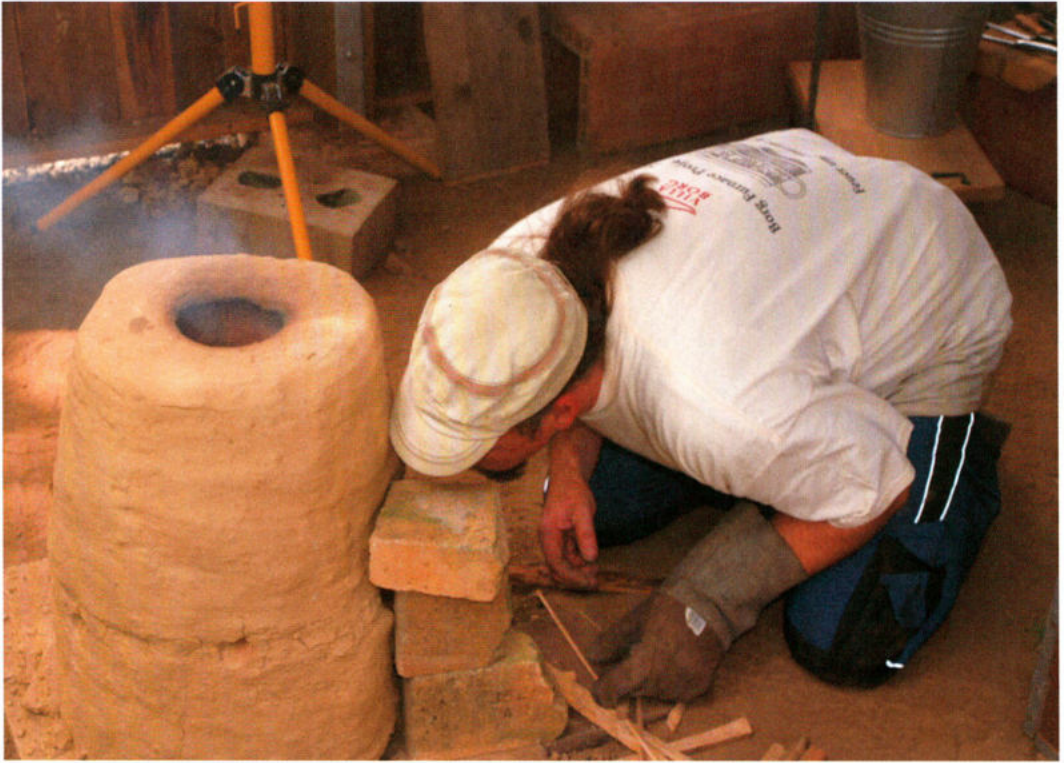
Abb. 2: Der erste Entwurf des Perlenofens PO-Borg-1 kommt noch nicht so richtig in Fahrt. – Struggling with the first layout of bead furnace PO-Borg-1 (14.6.2014).
