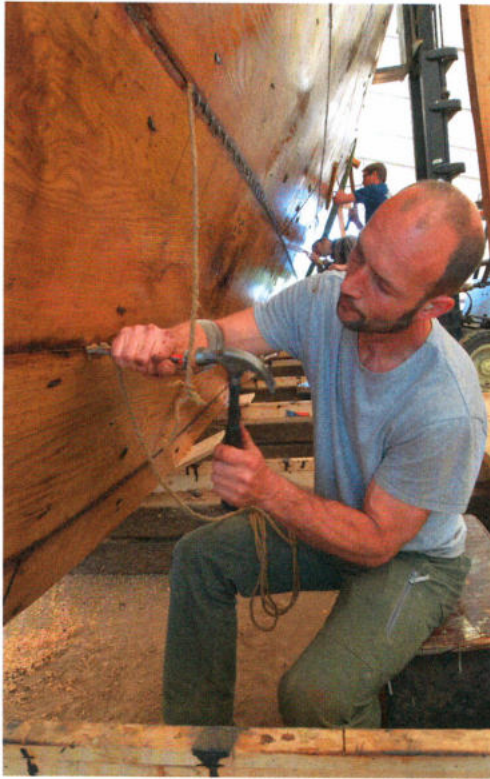
Abb. 5: Einbringung des Kalfats, Kalfatnägeln. – Caulking material and nails.
