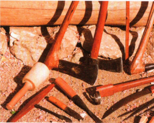
Abb. 9: Unsere eisenzeitlichen Werkzeuge: Tüllenbeil, Schaftlochaxt, Lappendechsel, Maßstock, Klopffholz, Löffelbohrer, Schnitzmesser, Tüllenstemmbeitel, Ziehmesser, Zugsäge, Zirkel und Reißahle sowie Holznägel. – Our Iron Age tools: Socketed hatchet, shaft hole axe, adze on a kneehafting, measure stick, knocking wood, spoon drill, carving knife, socketed chisel, drawing knife, drawing saw, compasses, awl and wooden nails.
