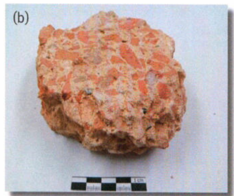
Abb. 1: Handstücke aus Xanten (1a) und Schwarzenacker (1b). Auffällig ist das sehr reine Weiß des Bindemittels aus Xanten. Das Bindemittel der Probe aus Schwarzenacker weist eine mehr ockerfarbene Färbung auf. – Samples from Xanten (1a) and Schwarzenacker (1b). Striking is the very pure white of the binder from Xanten. The binder of the sample from Schwarzenacker has a more ocher coloring.
