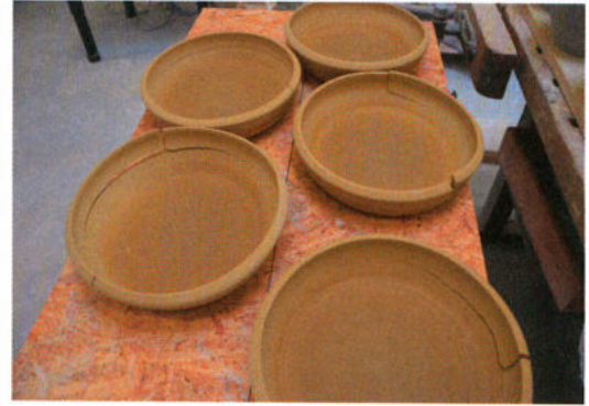
Abb. 9: Links: Ton 0001 – Deutlich ist der Schaden zu sehen, der beim Hochziehen und anschließendem Weiten während der Formgebung (Drehen) entsteht. Rechts: Ton 0002 – Die hohe Trockenschwindigkeit führte zu charakteristischen Trocknungsrisse bei Schalen. – Left: Clay 0001 – the cracks from raising and subsequent expanding of a thrown pot with this type of clay are apparent. Right: Clay 0002 – the high rate of shrinkage while drying lead to characteristic drying cracks when throwing shallow bowls.
