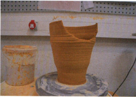
Abb. 9: Links: Ton 0001 – Deutlich ist der Schaden zu sehen, der beim Hochziehen und anschließendem Weiten während der Formgebung (Drehen) entsteht. Rechts: Ton 0002 – Die hohe Trockenschwindigkeit führte zu charakteristischen Trocknungsrisse bei Schalen. – Left: Clay 0001 – the cracks from raising and subsequent expanding of a thrown pot with this type of clay are apparent. Right: Clay 0002 – the high rate of shrinkage while drying lead to characteristic drying cracks when throwing shallow bowls.
