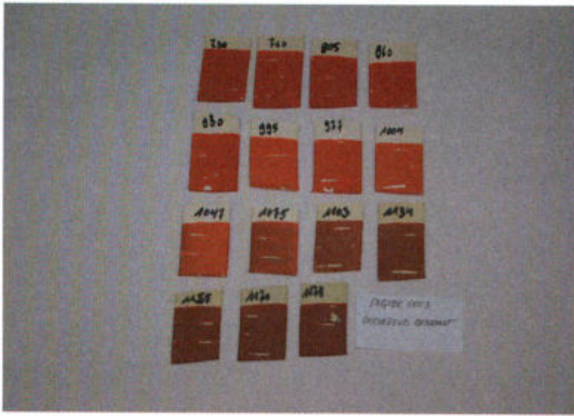
Abb. 11: Die Brenntafeln aus den Labortests zeigen exemplarisch die Engobentauglichkeit der untersuchten Tone. Links: Ton 0003 (rot; Geishecker Hof), rechts: Ton 0004 (Glanztone; Eichenweg). – The firing plaques from the laboratory tests exhibit the capability of the slip-glazes created from the different clays. Left: Clay 0003 (red, Geishecker Hof), right: Clay 0004 (luster clay, Eichenweg).
